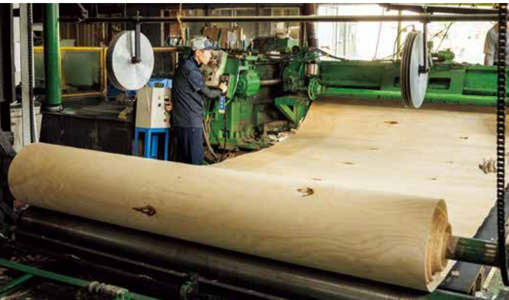
「ロータリーレース」と呼ばれる機械を使い、丸太をかつら剥きのように薄く剥いて合板の材料となる単板を製造。この工程を見学できる工場は国内では数少ない。
