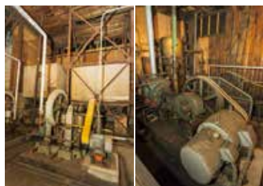
(左)2トンもの鍾(おもり)にポンプで水を送り、圧を蓄える蓄力機。(右)酵母などの微生物に酸素を供給するため、圧縮空気を送り込むコンプレッサー。
