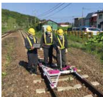
トラックマスターでレールの歪みを測定
