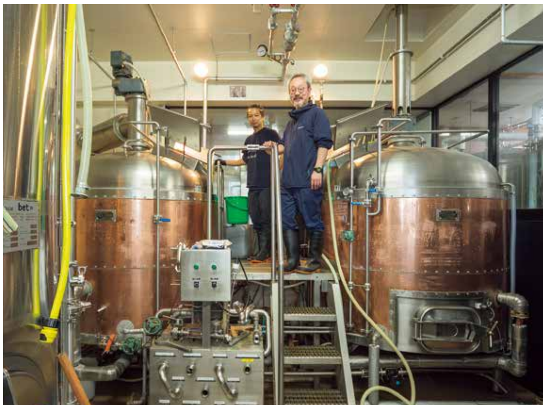
右が堤野さん。粉碎した麦芽に温水を加えて左の釜で煮込み、でんぷん質を糖化させるとおかゆ状の麦汁になる。それを右の釜でろ過して、液体を左の釜に戻す。そして何回かに分けてホップが投入される。
