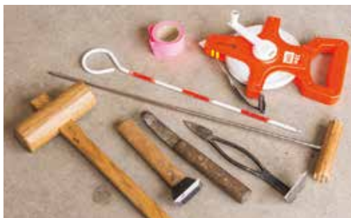
樹木医・齋藤さんの道具。左から、打音で異常を調べる木槌。健全な木は木魚のような硬い音、腐った木は濁った鈍い音がする。台形皮むき・ナイフ型フラン病削り・荒皮削りの3点は病気や害虫の食痕を削る。幹に刺して感触を調べる銅棒（こうぼう）。腐った箇所を目安に使うピンボール。幹周りを測る巻き尺、危険箇所の目印にする識別テープ。
