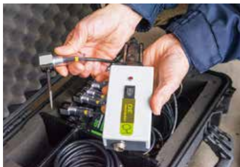
樹木を傷つけることなく、内部の腐朽率を精密診断できる機器。
