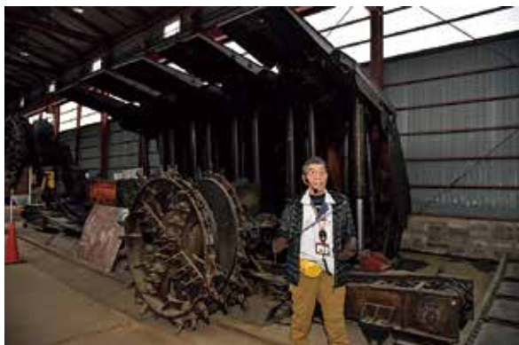
(左) 自走枠の前に立つ三上さん。大きな歯車状の機械(ドラムカッター)を回転させて、石炭を掘り崩す。その上の5枚の鋼板で坑道の天井部を支えた。(右) 坑道を掘進するロードヘッダー。断層やガス突出に注意しながら掘り進んだ。
