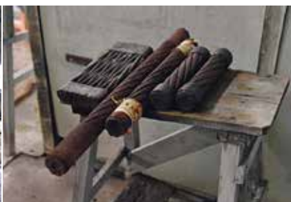
(左) 立坑槽の巻上機。電気力によって回転させ、鋼製ロープによってケージを昇降させた。(右) 強靱な鋼製ロープ。細い鋼線をより合わせ、直径約6cmの太いロープにしてある。
