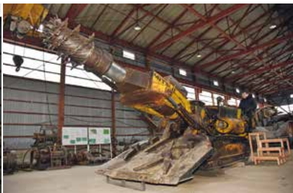
(左) 自走枠の前に立つ三上さん。大きな歯車状の機械(ドラムカッター)を回転させて、石炭を掘り崩す。その上の5枚の鋼板で坑道の天井部を支えた。(右) 坑道を掘進するロードヘッダー。断層やガス突出に注意しながら掘り進んだ。
