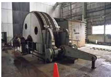
(左) 立坑槽の巻上機。電気力によって回転させ、鋼製ロープによってケージを昇降させた。(右) 強靱な鋼製ロープ。細い鋼線をより合わせ、直径約6cmの太いロープにしてある。
