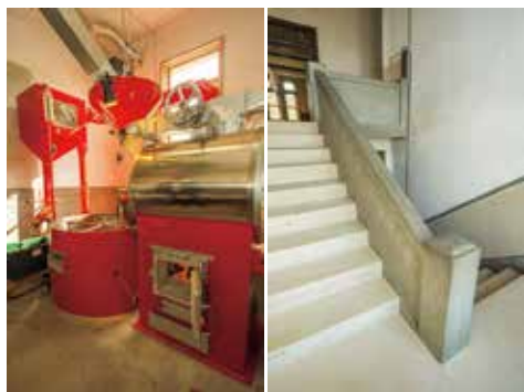
（左）ガスから炭火用にわざわざ改造した焙煎の機械。ここでも森の恵みが木炭となって文化を支える。（右）優れた左官職人の仕事ぶりが残されている階段の手すり。
